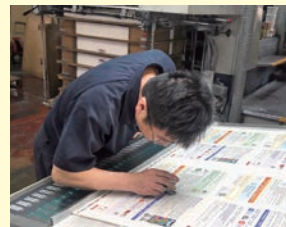
ルーペを使用してピンホールが発生していないかチェックします。
